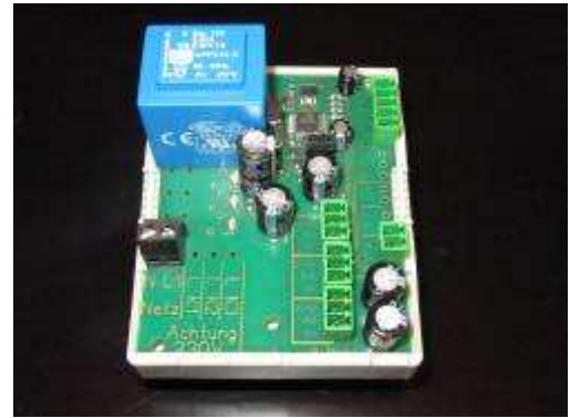
Hutschienenausführung l x b x h: 95x75x65mm)
