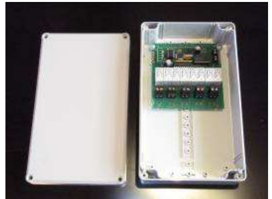
Aufputzgehäuse (l x b x h: 200x120x58 mm)
