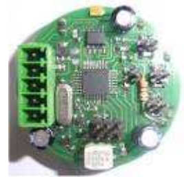
X-Modul: Durchmesser nur 43mm
