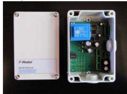
Aufputzgehäuse (l x b x h: 120x80x56 mm)
