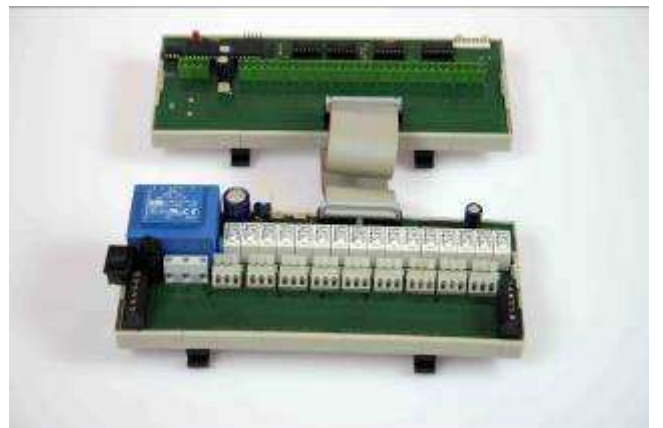
Unit III Hutschieneversion Masse: 232x97x60 je Platine
