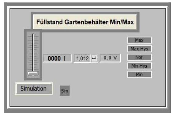
Dieses Makro ist zentraler Baustein für verschieden Funktionen in der Steuerung. Es überwacht die Wassertanks vor Überfüllung, die Pumpe als Trockenlaufschutz und vor zu hohen Drücken. Außerdem überwacht es in der Steuerung automatisierte Füllvorgängen der Wassertanks.
