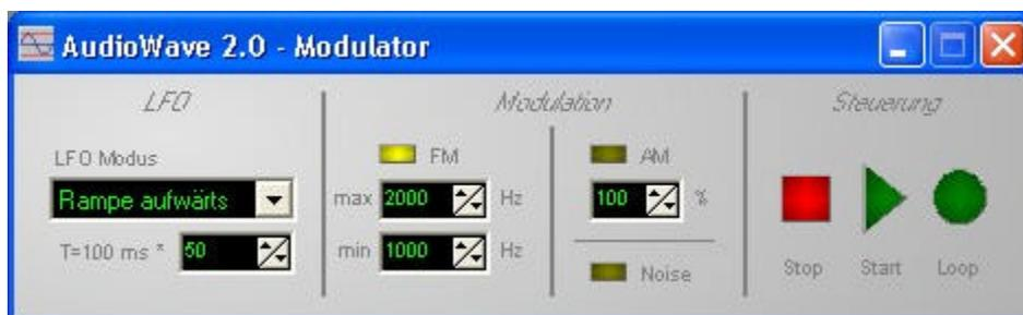
Mit dem Modulator können Sie frequenz- und amplitudenmodulierte Sinussignale und amplitudenmodulierte Rauschsignale erzeugen.
